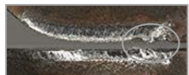
Filo de corte dañado
